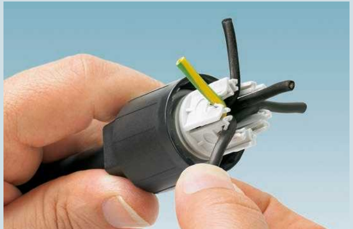
2. Adern in die Mutter einführen und in die gekennzeichneten (1, 2, 3...) Aderführungen einrasten.
